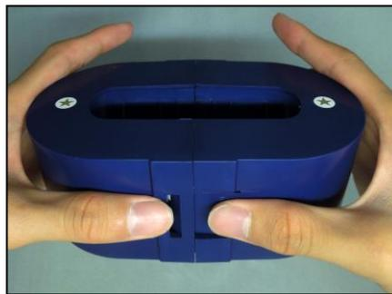
アウターケースの取り付け、取り外しは、左右の押さえ爪を 右手の親指、左手の中指で **同時に押しながら**してください。
